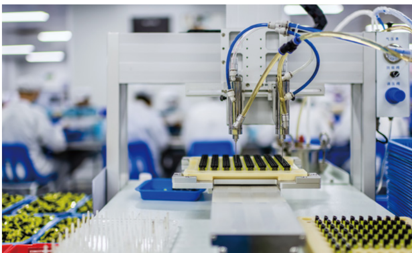
RELX悦刻专属工厂2020年为每条生产线配备一台自动滴液机,极大提升了给雾化芯滴油的效率
