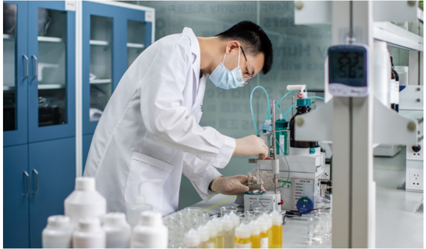
RELX 悦刻科学家使用电位滴定仪进行烟油的酸值测定，以确保出货烟油的酸值结果符合企标的规定
