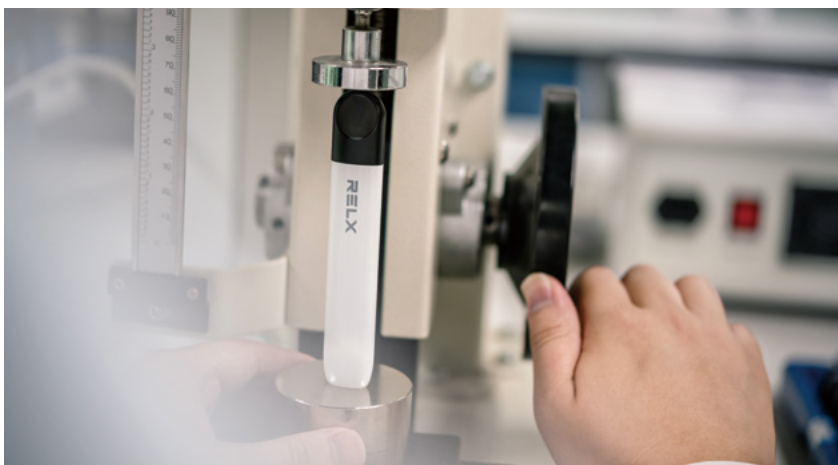
RELX 悦刻科研人员使用手动拉压力测试仪检测雾化杆的物理性能
